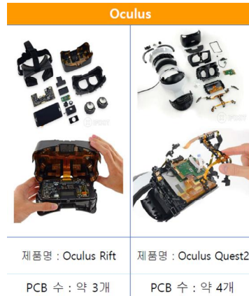
그림7. 오클러스 Quest 2: PCB 약 4개 탑재
