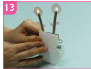
13 꽃을 꽂아 LED에 빛이 들어오는 것을 확인한다 (빛이 들어오지 않으면 꽃을 반대로 꽂는다)
