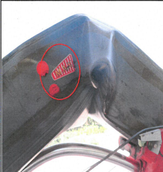
<사고가 발생한 고소작업대 붐대가 최대길이(Max)를 초과하여 인출된 모습>
