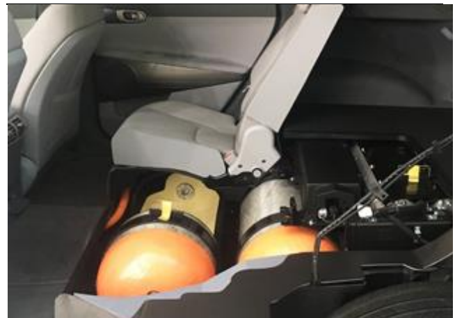
그림4. 넥소: 일진하이솔루스 Type4(700bar) 수소연료탱크 채택
