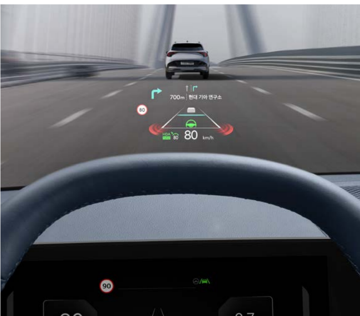
헤드업 디스플레이 윈드실드 글라스에 다양한 주행 정보를 투영시켜 보여줌으로써 운전자의 시선 이동을 최소화하여 안전한 운전을 도와줍니다.
