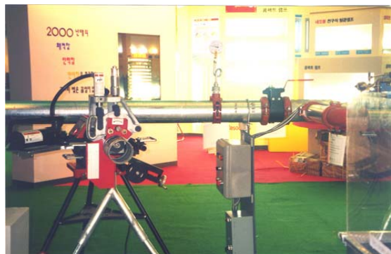
[그림17] 해체가 용이한 너트식 조립구조교체가 용이한 배관시스템
