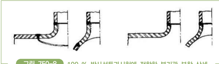
그림 750-8 100 % 방사선투과시험에 적합한 분기관 부착 상세
