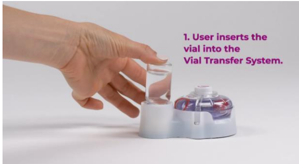
<그림4> Enable injections의 enFuse 사용법1
