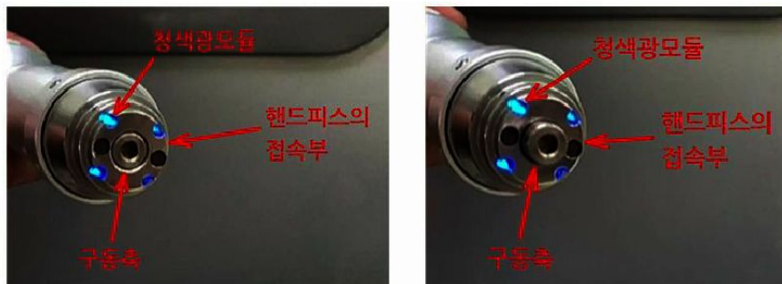
[갑 제9호증의 6, 7: 구동축의 인입(좌측) 및 돌출(우측) 상태]
