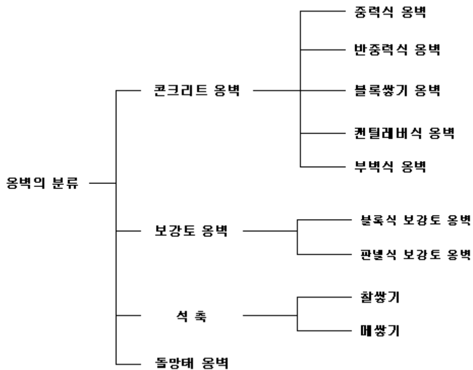
[그림 13.1] 재료형식에 따른 옹벽 분류
