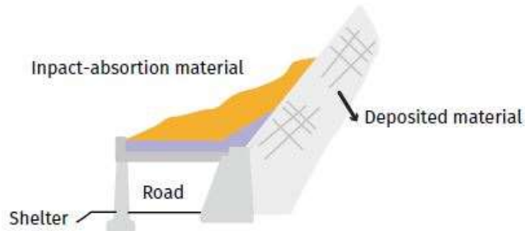
그림 4.5: 사면의 낙석 또는 붕괴 위험이 있는 도로를 위한 셸터 예
