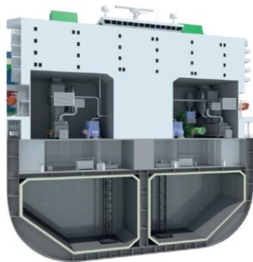
도표 5. 멤브레인 타입 LNG DF 연료창을 탑재한 선박 예)
