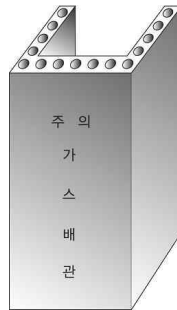
그림 2.5.8.3.1(4)③ “ㄷ” 형태의 철근콘크리트재 방호구조물
