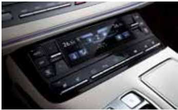
공기 청정 시스템 (듀얼 풀오토 에어컨/ 터치식 공조 컨트롤러 적용)
