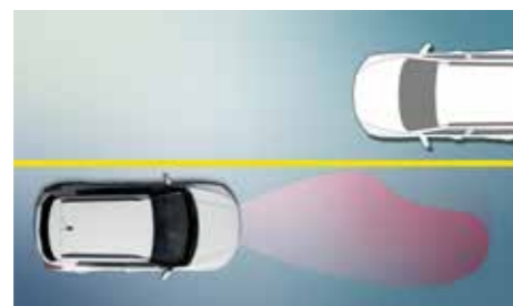
스마트 하이빔 SHB (Smart High Beam) 앞 차량의 리어 콤비 램프 및 맞은편 차량의 헤드램프, 주변 밝기 상태를 감지하여 상황에 적합하게 상향 또는 하향등으로 자동 전환해 줍니다.
