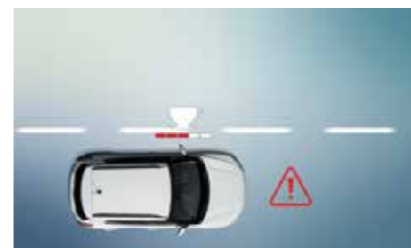
부주의 운전 경고 DAW (Driver Attention Warning) 차량 주행 패턴과 전방 카메라에 수집된 정보를 분석하여 운전자가 부주의하다고 판단되면 주의 운전 레벨을 단계별로 알려주는 안전 시스템입니다.
