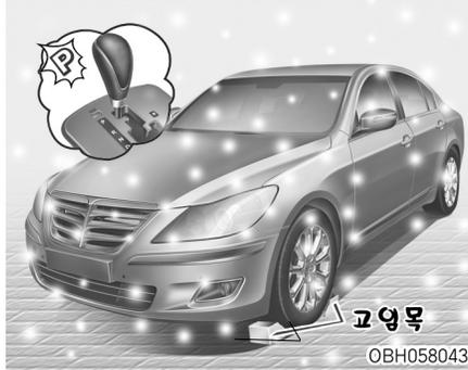
매우 추운 날씨의 주·정차 시 주차 브레이크를 작동시켜 놓으면 브레이크 장치가 얼어 붙어버릴 우려가 있으므로 주차 브레이크는 가능한 작동시켜 놓지 않는 방법으로 주차하십시오. 경사없는 평지에 변속레버를 「P」(주차) 위치로, 타이어에는 고임목을 받쳐 차가 움직이지 않도록 하십시오.
