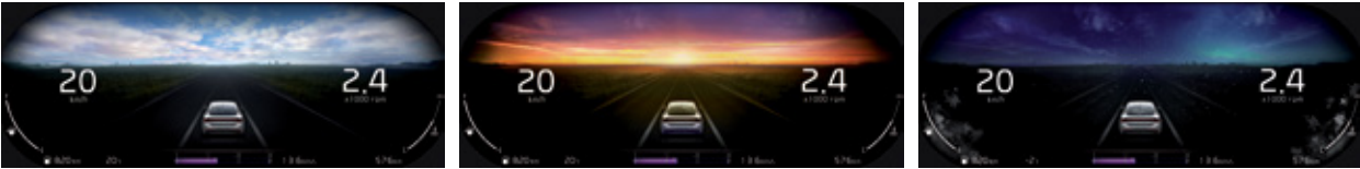
테마형 클러스터 날씨(맑음, 흐림, 비, 눈), 시간 등의 환경 변화에 따라 자동적으로 바뀌는 12.3인치 클러스터로 운전의 즐거움과 몰입감을 높여주는 기술입니다. (Kia Connect 개통 시)
