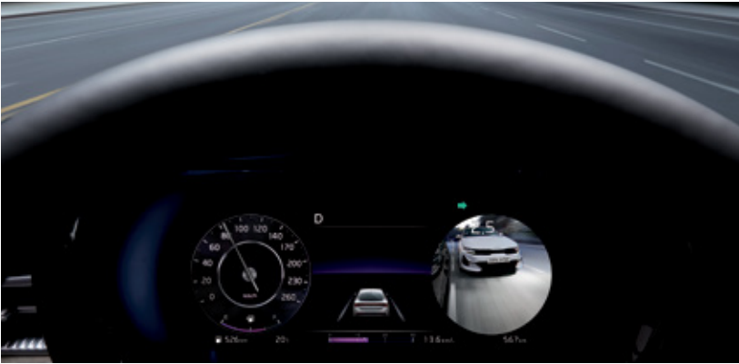
전방 차량 출발 알림* 정차 중 전방 차량이 출발하면 운전자에게 알려줍니다.
