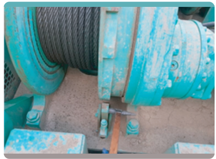
라이닝 간극 및 역회전방지 장치 작동상태 점검
