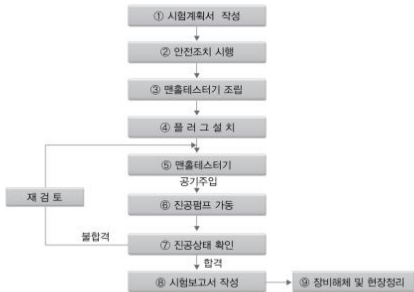
[그림 2-8-8] 맨홀 부공기압(진공시험) 절차모식도
