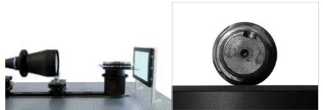
Fig. 34: bi-telecentric 렌즈 전체에 걸쳐 전체적으로 보여지는 두꺼운 물체의 이미지.
