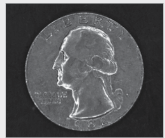
Fig. 10.b: 전면 밝은색 라이트(링조명)를 사용한 금속 제품의 영상(양각된 부품).
