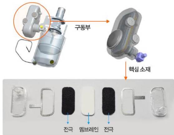
그림 3. 이오플로우 인슐린 펌프의 구동부, 독자 기술로 개발
