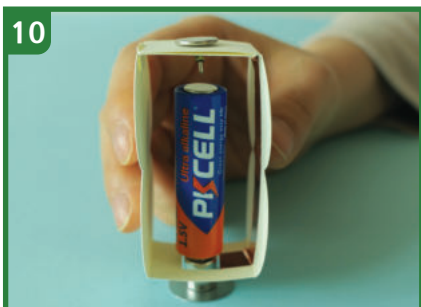
10 건전지의 밑면이 자석과 붙도록 하고 압핀이 뒷면 중앙에 닿게 중심을 잘 잡아줍니다
