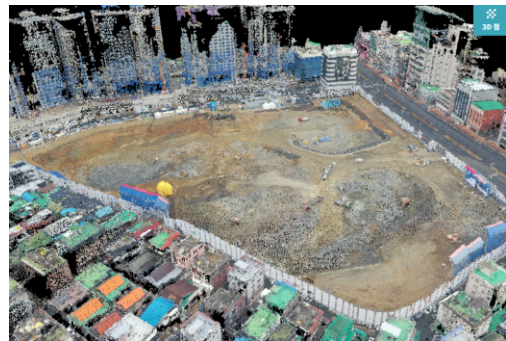
[LiDAR 드론 항공측량 활용 토공물량 검측]
