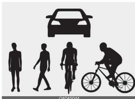
위 그림은 인식 센서가 차량 및 보행자 및 자전거 탑승자로 인지 가능한 이미지 예시입니다.
