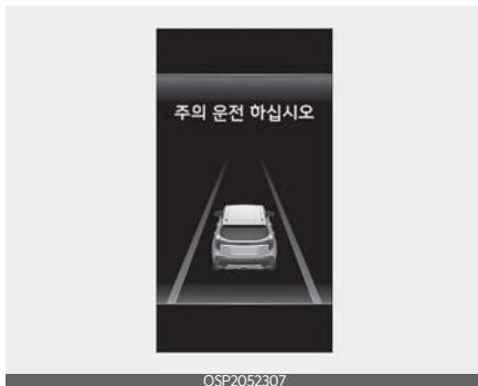
긴급 제동에 의한 정차 시 클러스터 등에 경고문이 표시됩니다. 안전을 위해 즉시 브레이크 페달을 밟고 주변 상황을 확인하십시오.
