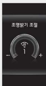
LCD 표시창에 밝기 정도가 표시되며, 최대 또는 최소 밝기 도달 시 알림음이 발생합니다(사양 적용 시).
