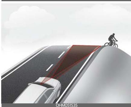
오르막길이나 내리막길에서는 전방에 있는 차량, 보행자 및 자전거 탑승자를 인식하지 못하여 전방 충돌방지 보조의 성능이 저하되어, 불필요하게 경고 또는 제동을하거나 도와주지 않을 수 있습니다. 또한 선행 차량, 보행자 및 자전거 탑승자를 갑자기 인식하여 속도가 빠르게 감속할 수 있습니다.
