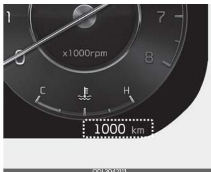
트립컴퓨터 모드 전환에 관계 없이 적산거리계를 항상 표시합니다. 차량 출고 시 적산거리계가 90 km 미만은 정상입니다.
