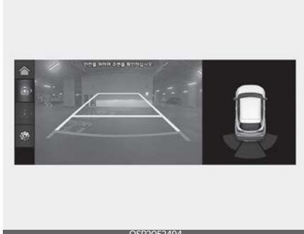
사이드 미러(실외 미러) 경고등, 경고문, 경고음을 통해 충돌 경고를 알립니다. 인포테인먼트 시스템 화면의 후방 영상에도 경고가 표시됩니다(사양 적용 시).
