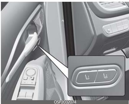
운전석 메모리 시트는 사전에 운전석 위치, 헤드업 디스플레이(사양 적용 시) 등을 저장해 두고, 실행 버튼을 누르면 저장한 상태로 자동으로 조절하는 장치입니다.
