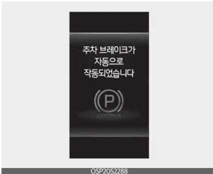
자동 정차 기능 (Auto Hold) 작동 상태에서 전자식 파킹 브레이크(EPB) 체결 상태로 전환된 후 LCD 표시창에 경고 문구가 표시되고 경고음이 1회 울립니다.
