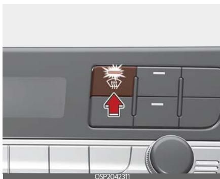
앞유리 서리 제거 버튼을 누르면 버튼 내 표시등이 켜지고 표시창에 앞유리 서리 제거 표시가 나타납니다. 유리창 습기 방지 기능이 설정된 경우 외기 유입이 자동으로 선택되며 바깥 온도에 따라 에어컨도 자동으로 작동합니다. 풍량 조절 스위치를 눌러 원하는 풍량을 설정하십시오.
