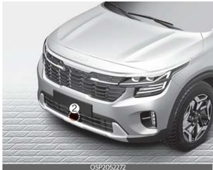
전방의 차량을 인식하기 위해 전방 카메라와 전방 레이더를 인식 센서로 사용합니다. 인식 센서의 위치는 위 그림을 참고하십시오.
