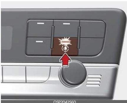
공기 청정 모드 버튼을 누르면 오염된 외부 공기를 차단하고, 실내 공기를 순환시켜 쾌적한 실내 공기를 제공합니다. 5분간 작동 후 이전 설정된 모드로 변경됩니다.
