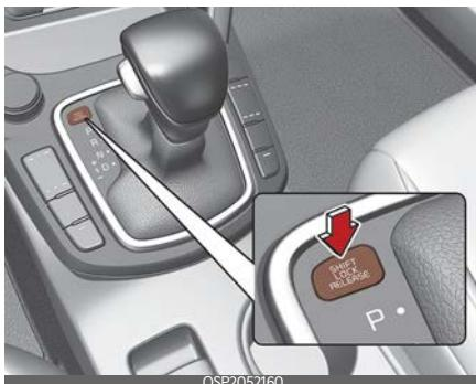
1. 차량을 정차한 후 브레이크를 밟고, 엔진 시동 상태 또는 시동 스위치 「ON」 상태에서 변속 레버를 「P」(주차) 위치로 두십시오.
