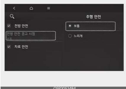
전방 충돌방지 보조의 경고 시점을 변경하려면 시동 'ON' 상태에서 클러스터의 **사용자 설정** → **운전자 보조** → **주행 안전** → **전방 안전 경고 시점** 또는 인포테인먼트 시스템의 설정
