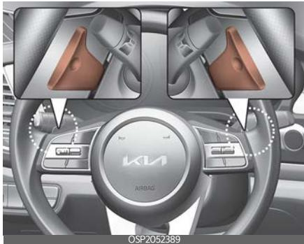
변속 레버 및 다이얼이 「D」(주행) 및 수동 모드에서만 작동하며 변속 위치에 따라 다음과 같이 작동합니다.
