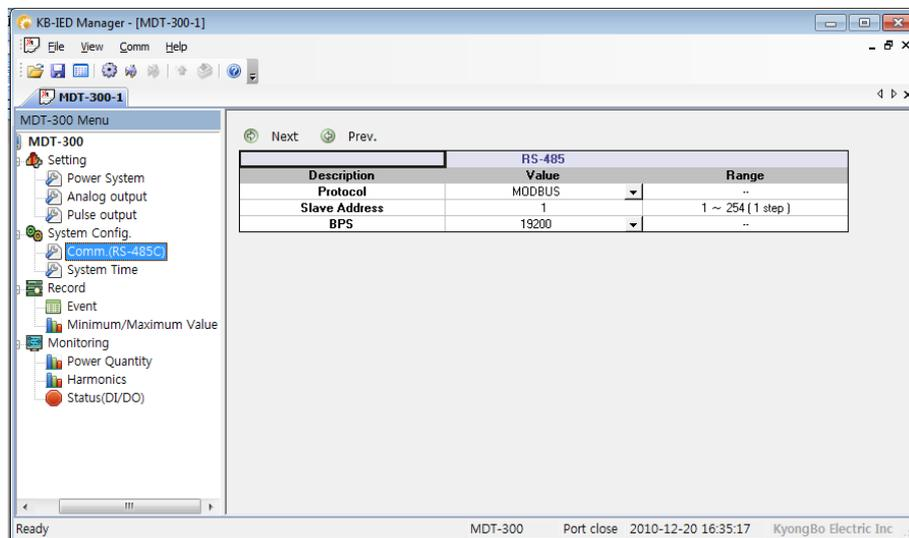
**[그림 10.6] KB-IED Manager / System Config. / Comm(RS-485C)**
