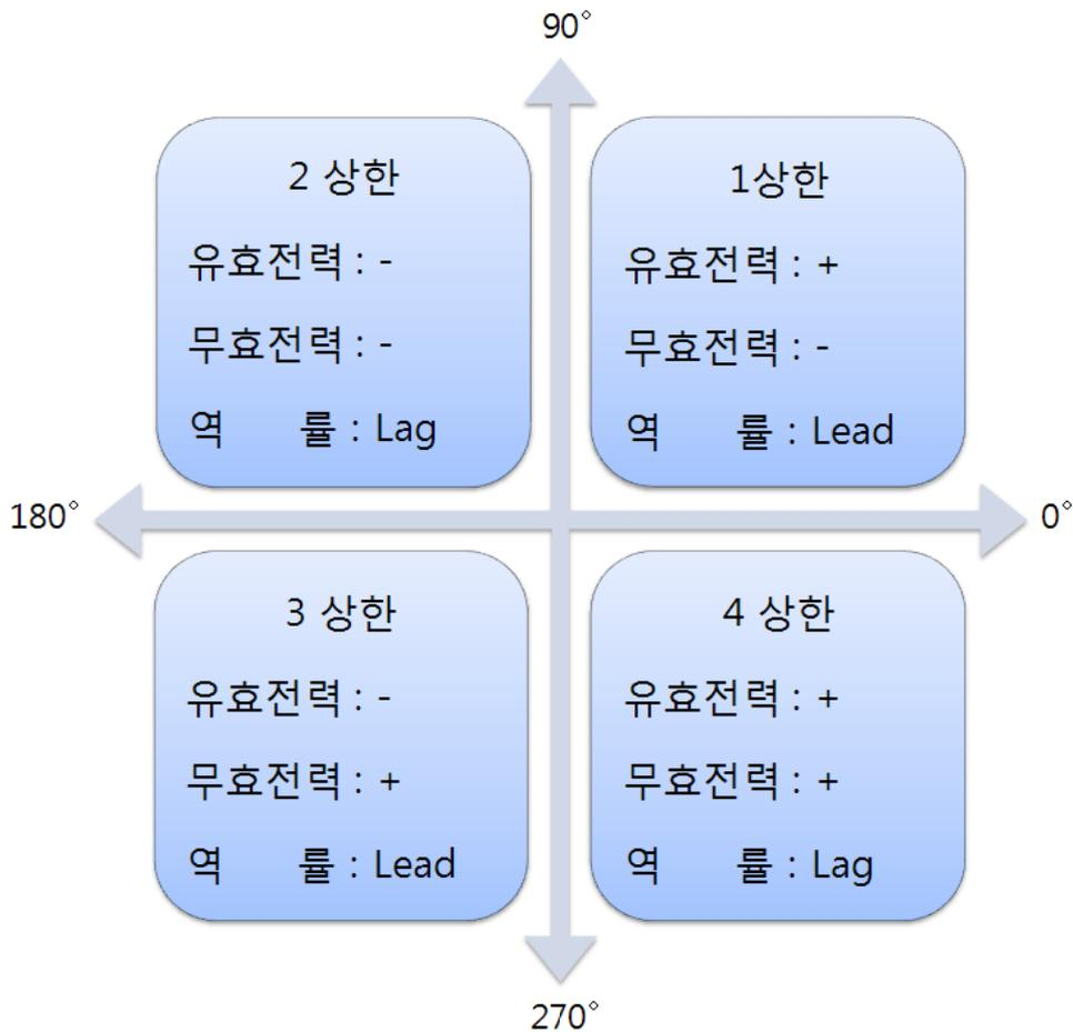
【그림 4.1】 전력과 역률의 방향 및 부호 표시
