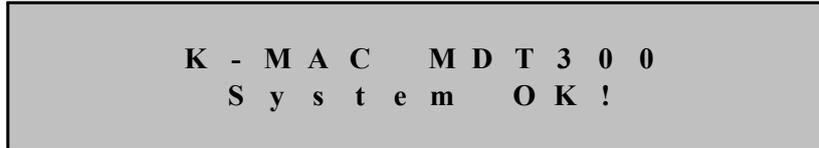
장치에 이상이 있을 때는 System OK! 대신 System Error! 가 표시됩니다.
