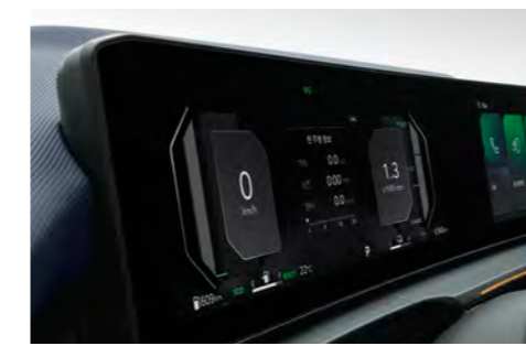
슈퍼비전 클러스터 (12.3인치 풀사이즈 칼라 TFT LCD)
