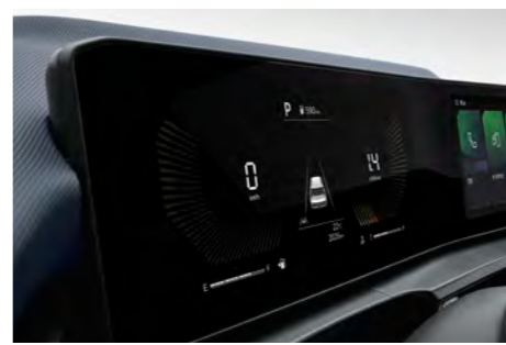
슈퍼비전 클러스터 (4.2인치 칼라 TFT LCD)
