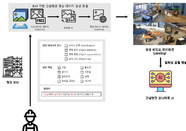
그림 5 BIM 기반 건설현장 영상데이터 생성기술 활용 시나리오
