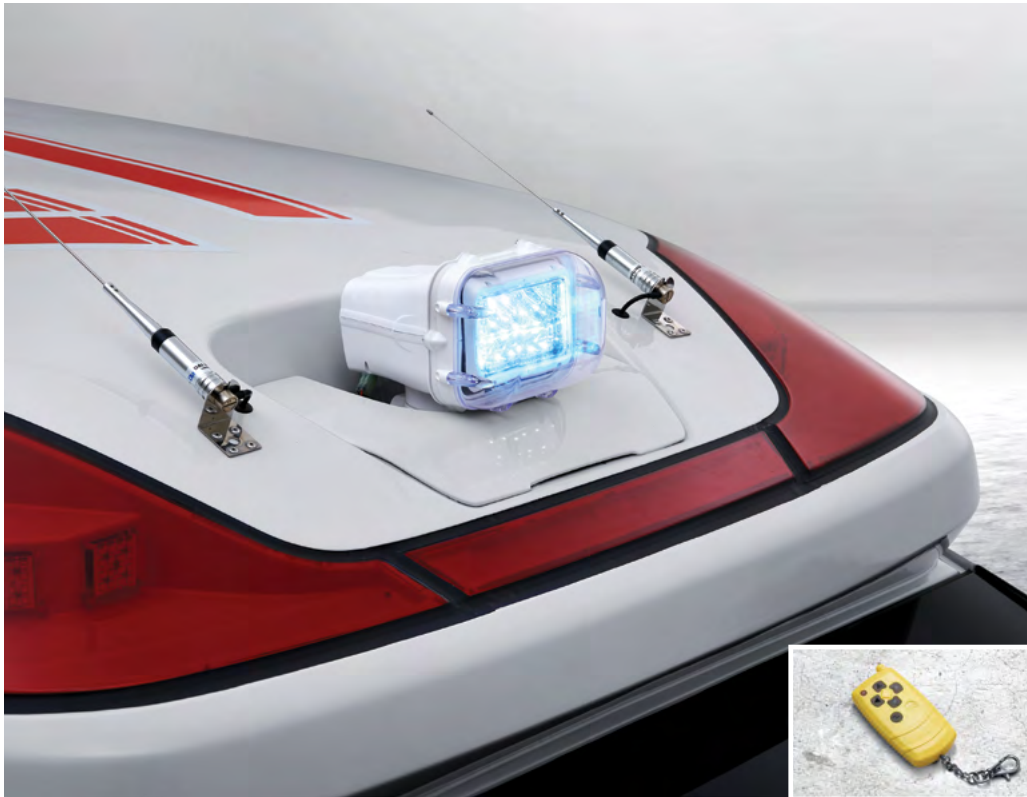
써치라이트 및 리모컨(선택사양) 야간 구급활동 시 차량주변을 상하좌우로 조명을 비출 수 있습니다.
