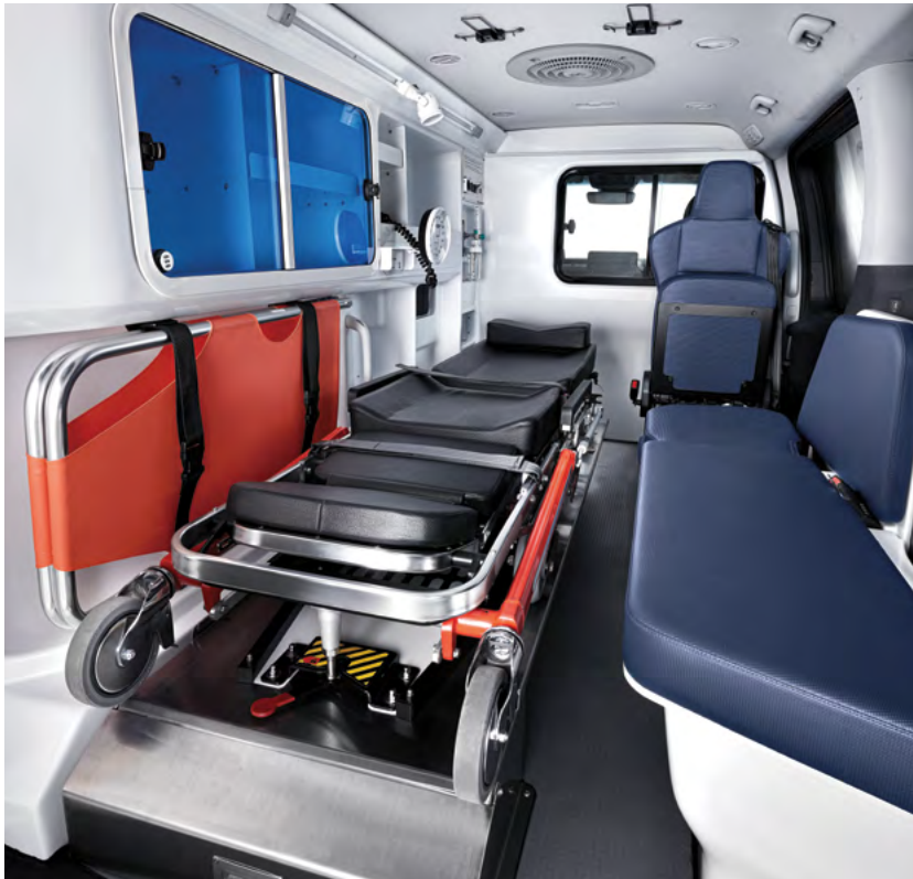
주들것(링크식) 응급요원 1인만으로 환자의 후송 및 차량탑승이 가능합니다.
