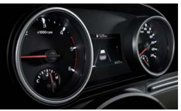
슈퍼비전 클러스터 (4.2인치 칼라 TFT LCD)
