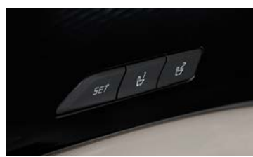
운전자세 메모리 시스템 (운전석 시트, 아웃사이드 미러)
