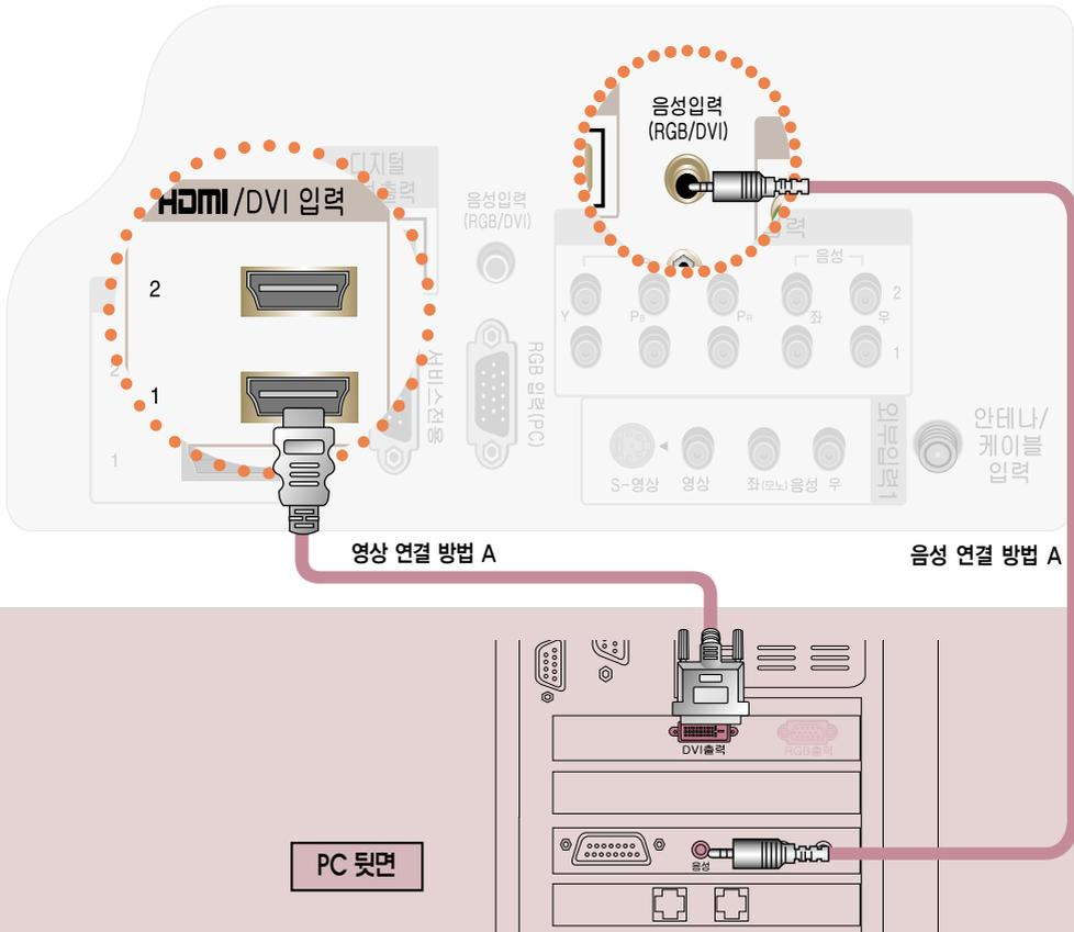
**영상 연결 방법 A.** HDMI to DVI 케이블로 TV 뒷면의 「HDMI/DVI 입력1」 단자와 PC 뒷면의 「DVI 출력」 단자를 연결하세요. 「HDMI/DVI 입력2, 3」 단자에 연결할 수도 있습니다.
