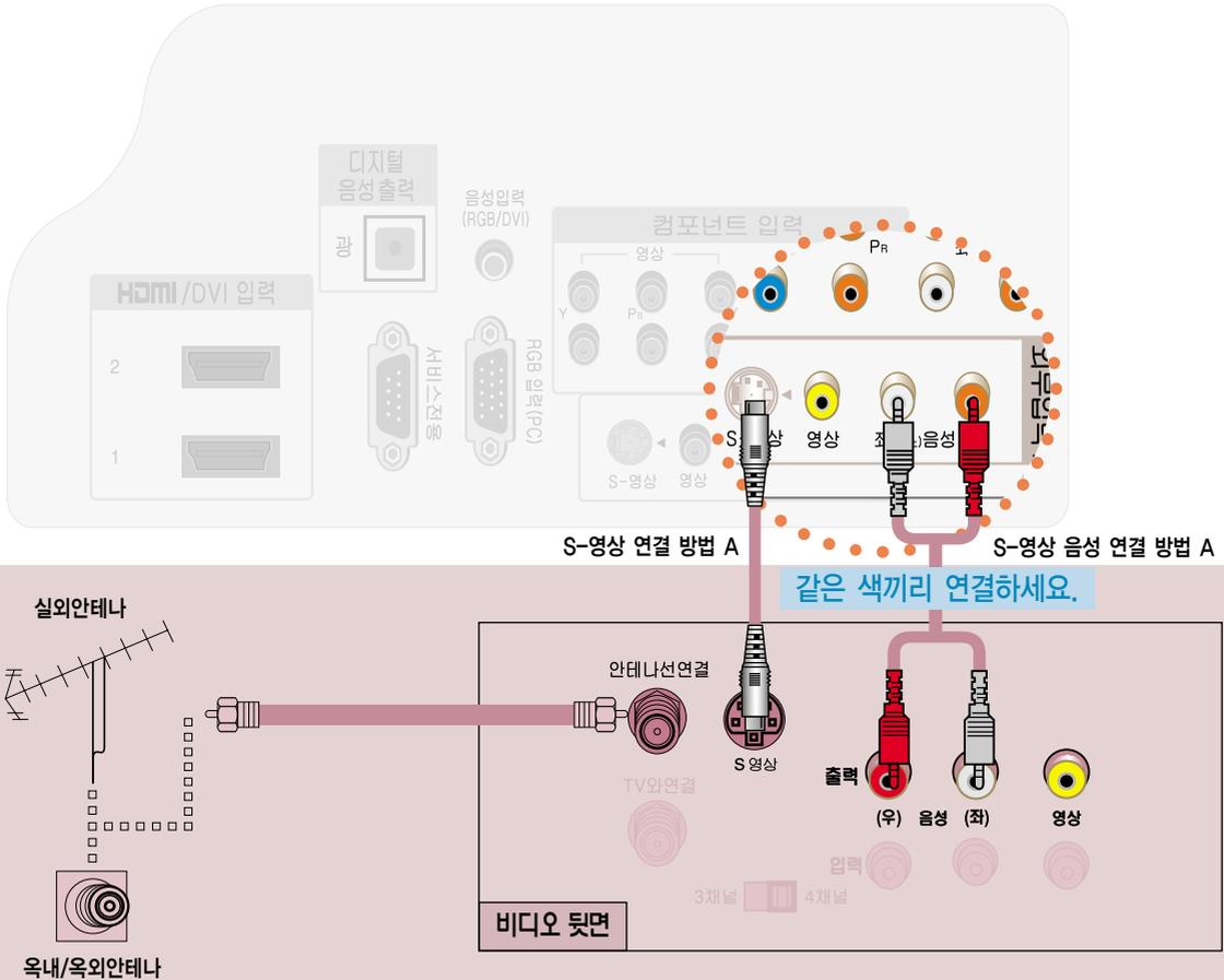
**방법 A.** 동축선으로 옥내/옥외 안테나 단자와 비디오 뒷면의 「안테나선연결」 단자에 연결한 후, TV 뒷면 「외부입력1」의 「S-영상」 단자와 비디오의 「S-영상」 단자를 S-영상 연결선으로 연결하세요. S-영상으로 연결할 경우 음성은 「외부입력1」의 「음성 좌, 우」 연결 단자에 연결하세요.
