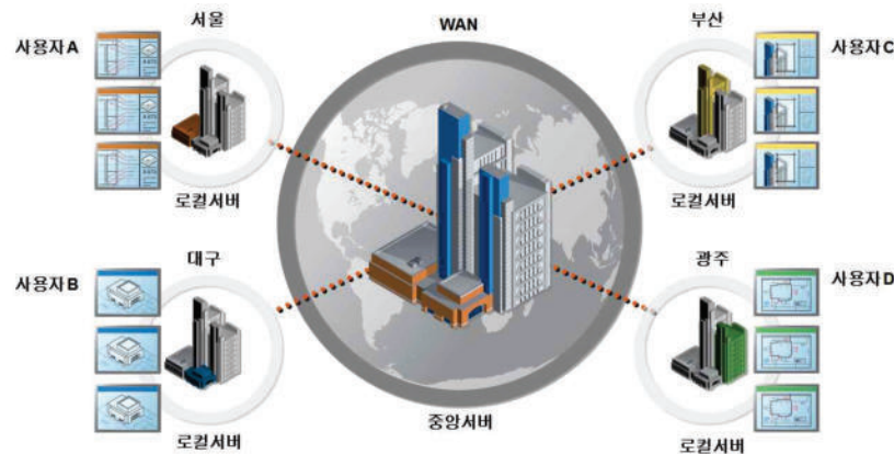
[그림 176] BIM Server의 구축 개념 예시 ((주)오토테스크 코리아 제공)
