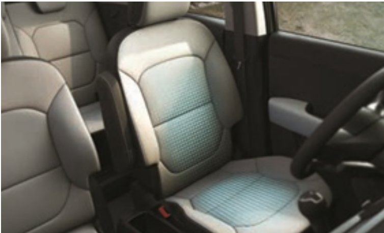
운전석 통풍시트* 시트 내 설치된 통풍 팬으로 바람을 발생시켜 쾌적한 운전 환경을 제공합니다.
