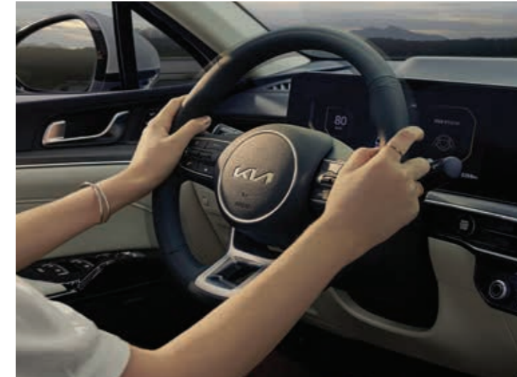
스티어링 휠 진동경고* 주행 중 전방, 후측방에서 충돌 위험이 감지되거나 운전자 주의가 필요할 시 스티어링 휠 진동을 통해 직관적으로 위험 상황을 알려주고 더욱 안전한 주행을 도와줍니다.
