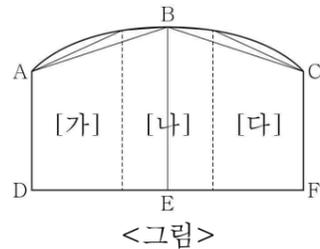
이처럼 선박의 수직 단면적을 구하면, 이 수직 단면적에 선박의 길이를 곱해 부피를 구해야 한다. 하지만 대부분의 선박은 그 형태로 인해 수직 단면적이 변화하고, 특히 선수와 선미 부분에서는 변화 폭이 크므로 다시 심프슨 공식을 사용해야 한다. 선박의 물에 잠길 부분의 부피를 구할 때에는 단면적 곡선이 그려진 그래프를 이용한다. 먼저 수평축은 일정한 길이의 구역으로 분할된 선박 측면에서의 위치로, 수직축은 선박의 수직 단면적으로 설정한다. 심프슨 공식을 활용해 각 구역의 특정 지점의 수직 단면적을 구한 후 이를 그래프에 점으로 나타낸다. 그리고 각각의 점을 연결하면 단면적 곡선이 되는데, 심프슨 공식을 이용해 이 곡선 내부의 면적을 구하면 선박의 부피를 추정할 수 있다.
