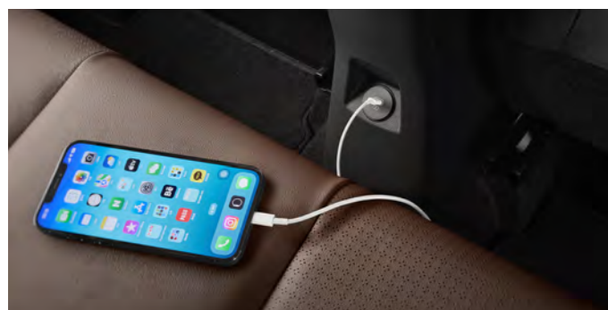
뒷좌석 C타입 USB 단자 (충전용) 슬라이딩 센터 콘솔 암레스트 후면부에 C타입 USB 단자를 적용하여 최신 디바이스와의 호환성을 높였으며, 뒷좌석 탑승객이 편리하게 충전할 수 있도록 하였습니다.
